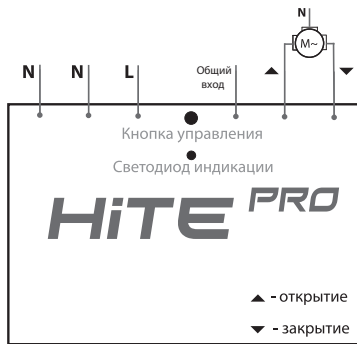
Схема подключения блока Relay-Drive C с выходом «сухой контакт»
